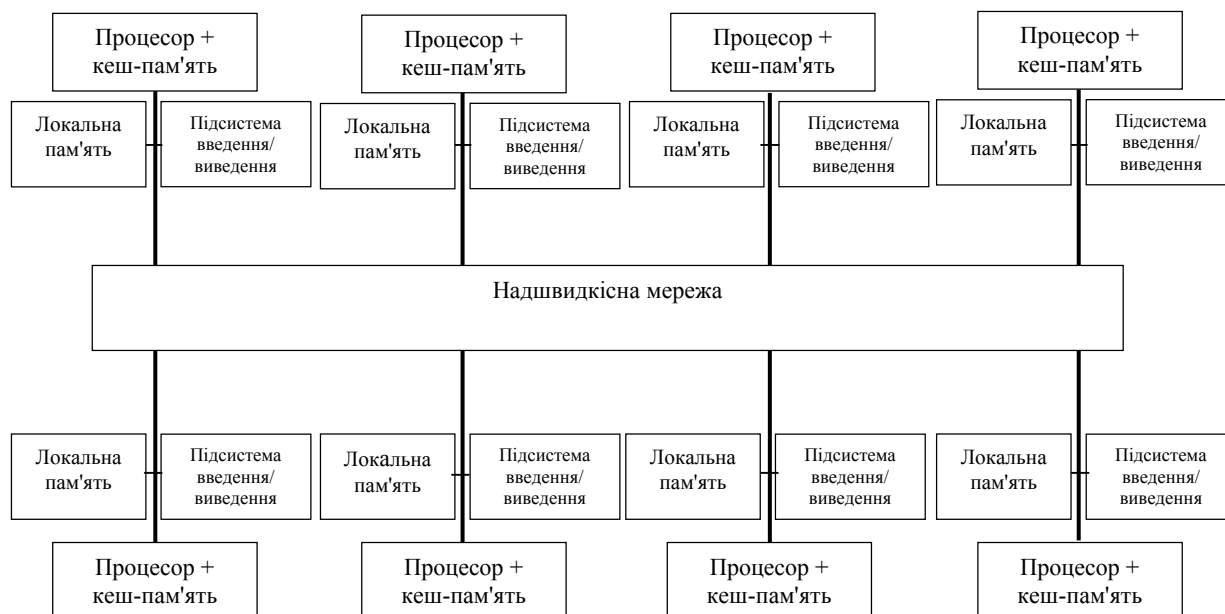
Рис.6.5. Типова архітектура КС з розподіленою пам'яттю.
